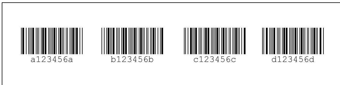
8. ábra: Codabar vonalkód
